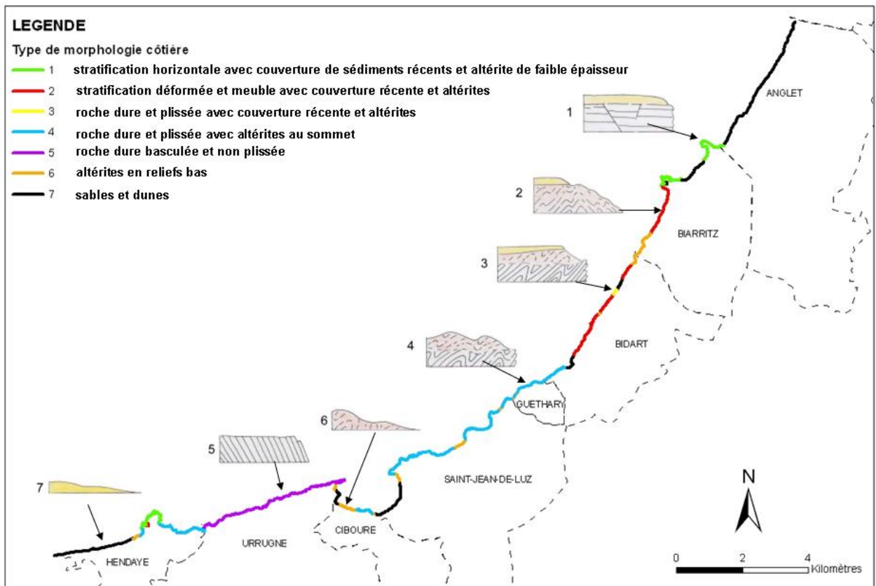
Illustration 30 - Types de morphologie côtière sur les communes littorales de la côte basque (Genna et al., 2004)
