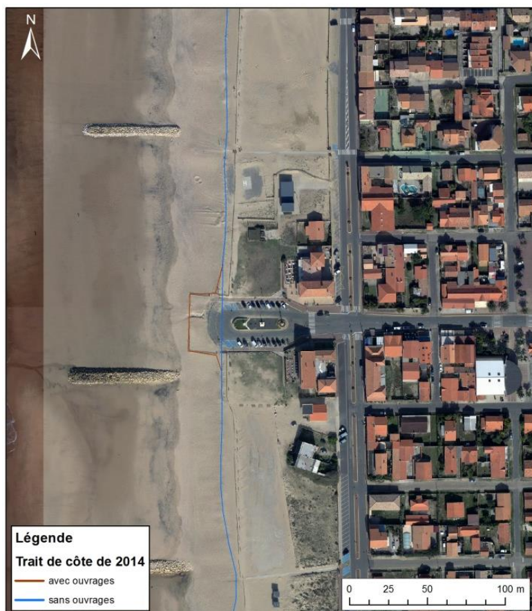
Illustration 10 - Interprétation de la position du trait de côte dans l'hypothèse d'effacement des ouvrages côtiers : exemple sur la commune de Vendays-Montalivet (l'épi central a été supprimé depuis la prise de vue de l'illustration ci-dessus, datant de 2014) (fond cartographique : @IGN, OCA 2014)
