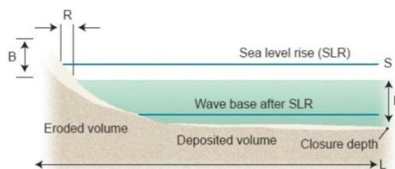
Illustration 16 - Schéma des paramètres pris en compte pour l'application de la règle de Bruun, avec une translation verticale et vers la terre du profil d'équilibre à cause d'une élévation du niveau de la mer (d'après Pilkey et Cooper, 2004)
