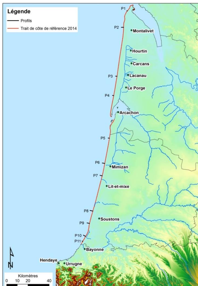
Illustration 17 - Localisation des profils utilisés pour l'application de la méthode de Bruun sur le littoral aquitain
